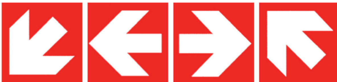
Obrázek 20: SMĚROVKA (DOLŮ, VLEVO, VPRAVO, NAHORU) K ZAŘÍZENÍ POŽÁRNÍ OCHRANY
