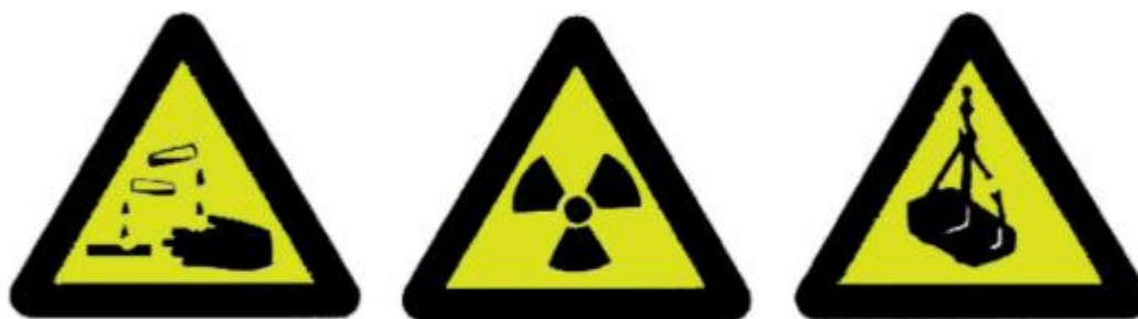
Imagine 5: ATENȚIE, RISC DE COROZIUNE SAU OXIDARE - SUBSTANȚE RADIOACTIVE PERICULOASE - ATENȚIE LA SARCINILE SUSPENDATE
