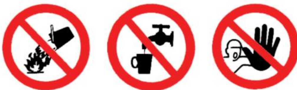
Рисунок 2: ЗАБОРОНЯЄТЬСЯ ГАСИТИ ВОДОЮ – НЕПИТНА ВОДА – ДОСТУП СТОРОННІМ ЗАБОРОНЕНО
