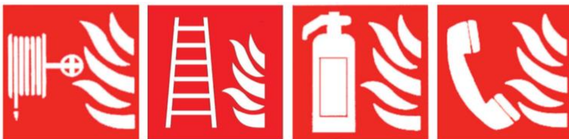
Изображение 19: ПРОТИВОПОЖАРЕН МАРКУЧ – ПРОТИВОПОЖАРНА СЪЛБА – ПОЖАРОГАСИТЕЛ – ТЕЛЕФОН ПРИ ПОЖАР
