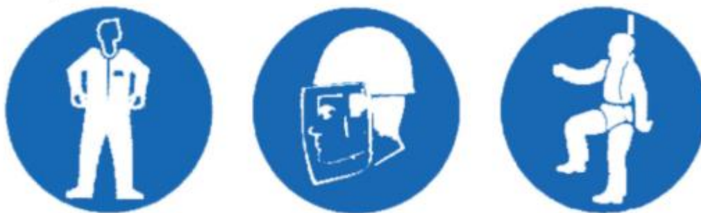
Изображение 12: ЗАДЪЛЖИТЕЛНО ИЗПОЛЗВАНЕ НА ЗАЩИТНО РАБОТНО ОБЛЕКЛО – ЗАДЪЛЖИТЕЛНО ИЗПОЛЗВАНЕ НА ПРЕДПАЗНИ СРЕДСТВА ЗА ЛИЦЕ – ЗАДЪЛЖИТЕЛНО ИЗПОЛЗВАНЕ НА ПРЕДПАЗНИ КОЛАНИ
